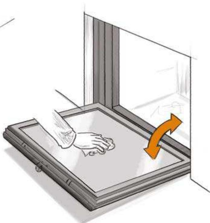
Afin de permettre le nettoyage de la vitre et l'entretien, le cadre bascule, sans nécessité de démontage.
